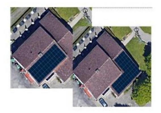
PV - Generatorleistung: 66,1 kWp PV - Generatorenergie: 62.780 kWh Speicher von ca. 22 kWh
